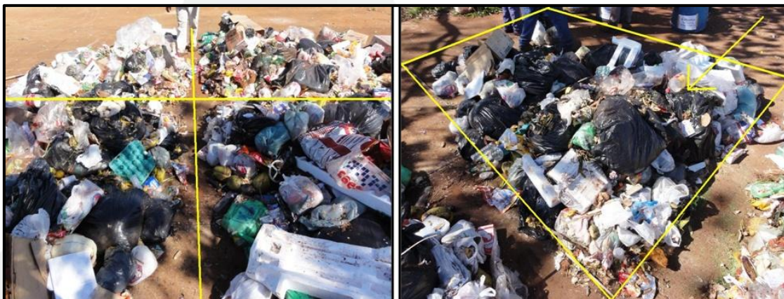
Figura 12 - Etapa quarteamento da gravimetria
